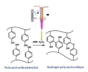
Mécanisme réactionnel envisagé pour la gélification enzymatique (peroxydase) de polysaccharides phénolisés traités par plasma froid.
