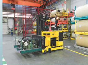
AGV déplaçant des bobines
