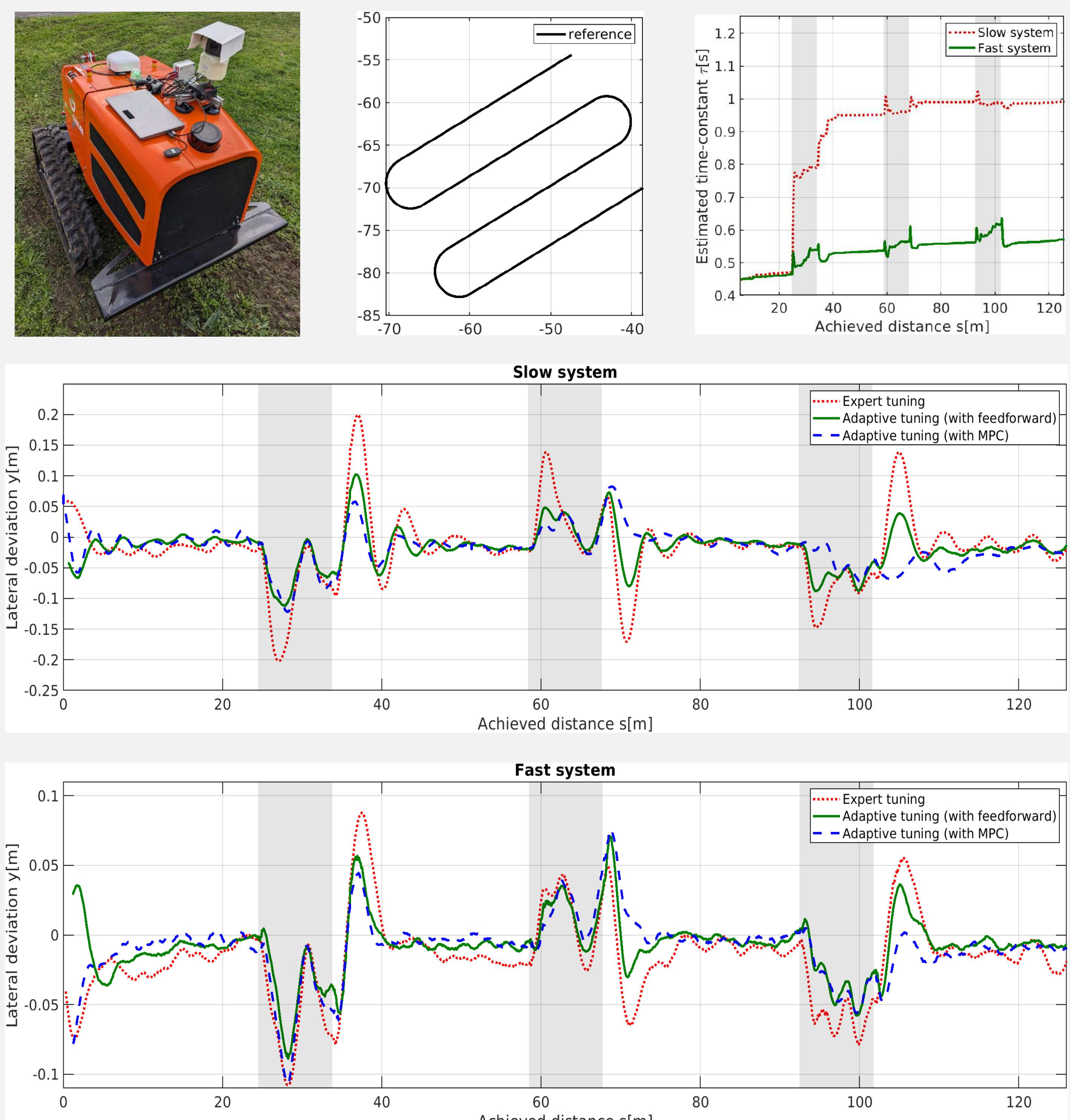
La nouvelle approche permet d'adapter les gains et paramètres de prédiction en fonction de l'estimation de  $\tau$ . Ainsi, de meilleures performances de suivi de trajectoire sont obtenues quel que soient les capacités de la machine.
