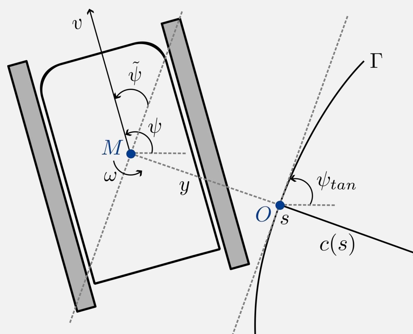
Pour le suivi d'une trajectoire  $\Gamma$  à une vitesse donnée  $v$ , on détermine  $\omega = \omega_y + \omega_c$  :
