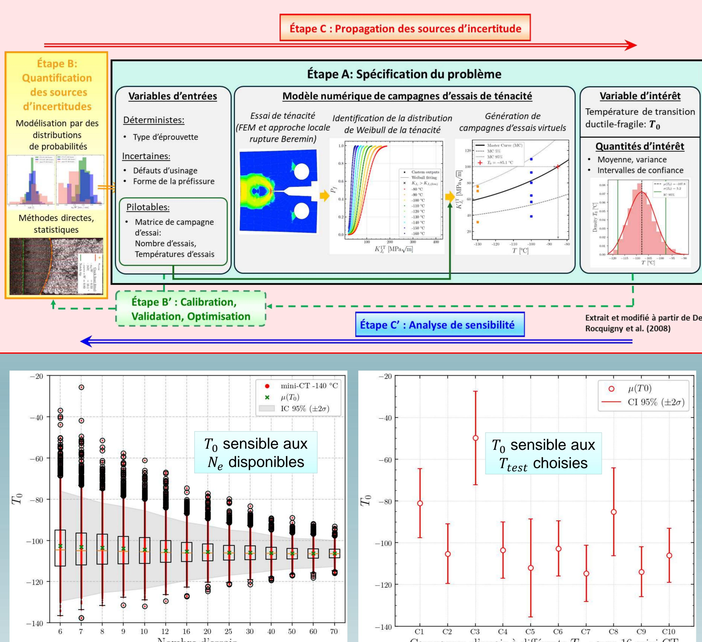
➤ **Objectif:** Trouver la séquence de températures d'essais optimale qui minimise la variance d'estimation  $T_0$ , sous budget fixé  $\Leftrightarrow S_{T_{test}}^* = \arg \min \text{Var}_{T_0}(S_{T_{test}})$
