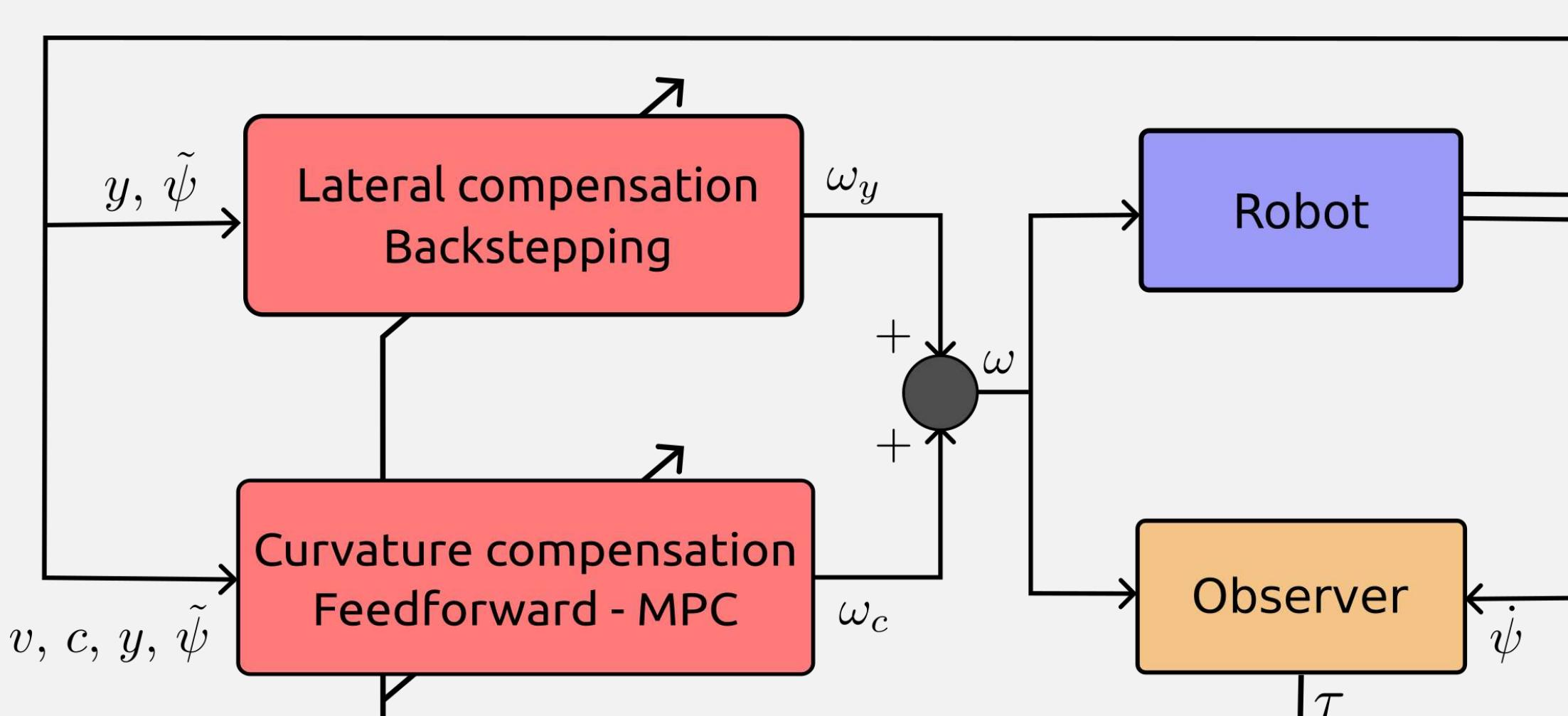
L'observateur non linéaire évalue la réactivité du système robotique via l'estimation d'une constante de temps  $\tau$  associée à un modèle d'ordre 1. Les gains du backstepping, et les paramètres des approches prédictives sont ajustés. Le contrôleur est ainsi adapté aux capacités du véhicule.
