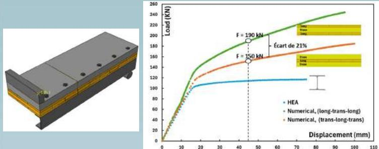
Comparaison entre deux configurations des panneaux CLT (0°, 90°, 0° et 90°, 0°, 90°) dans le cas d'une poutre mixte démontable acier/CLT/béton
