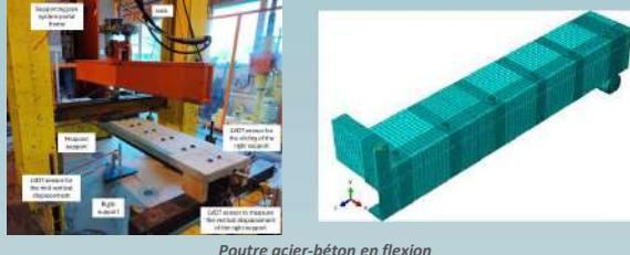
Poutre acier-béton en flexion
