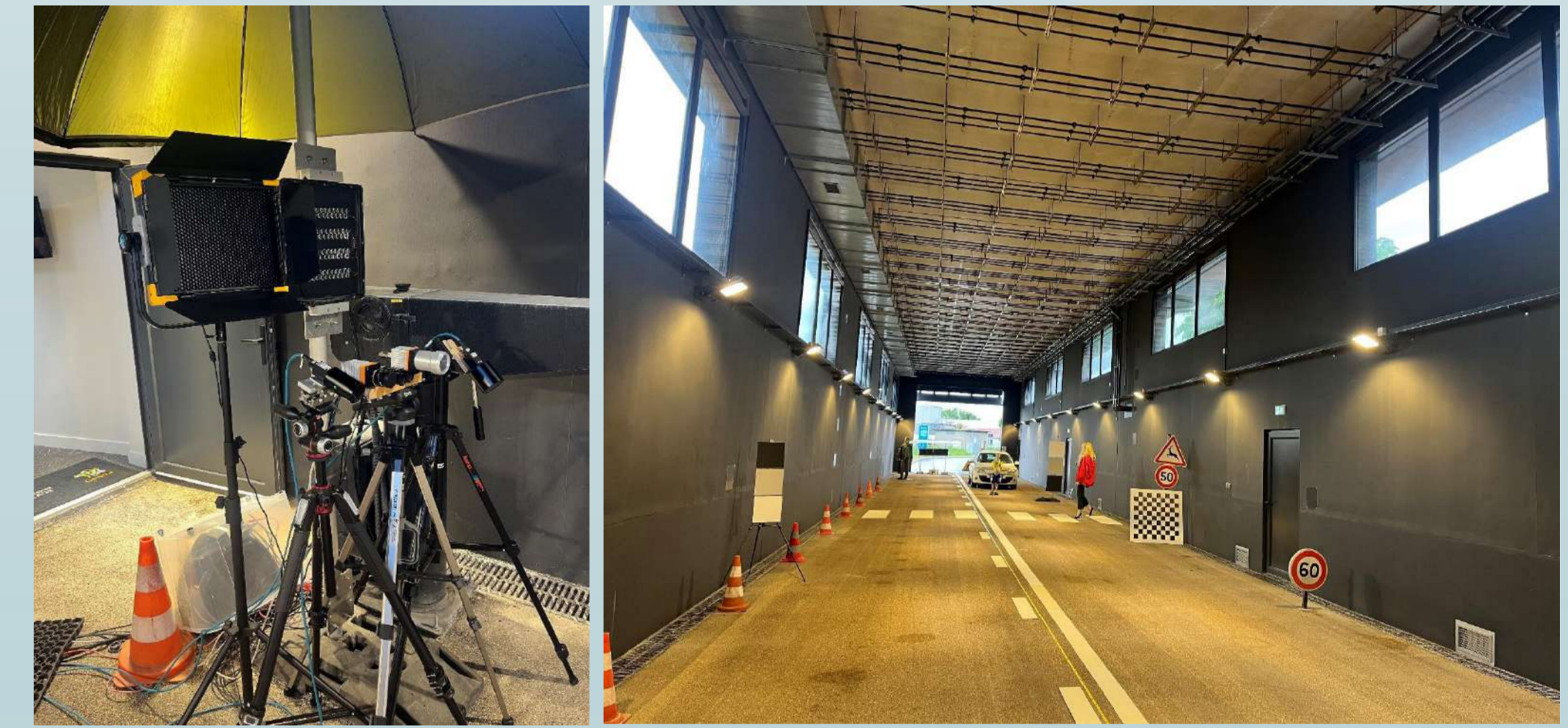
Figure 2: Plateforme PAVIN météo extrême (brouillard et pluie) située à Clermont Ferrand, elle a 50 m de long et 7 m de large.
