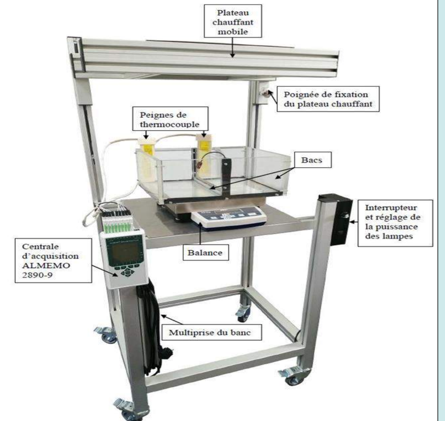
Fig.6 – Banc expérimentale pour évaluer le comportement thermique des revêtements
