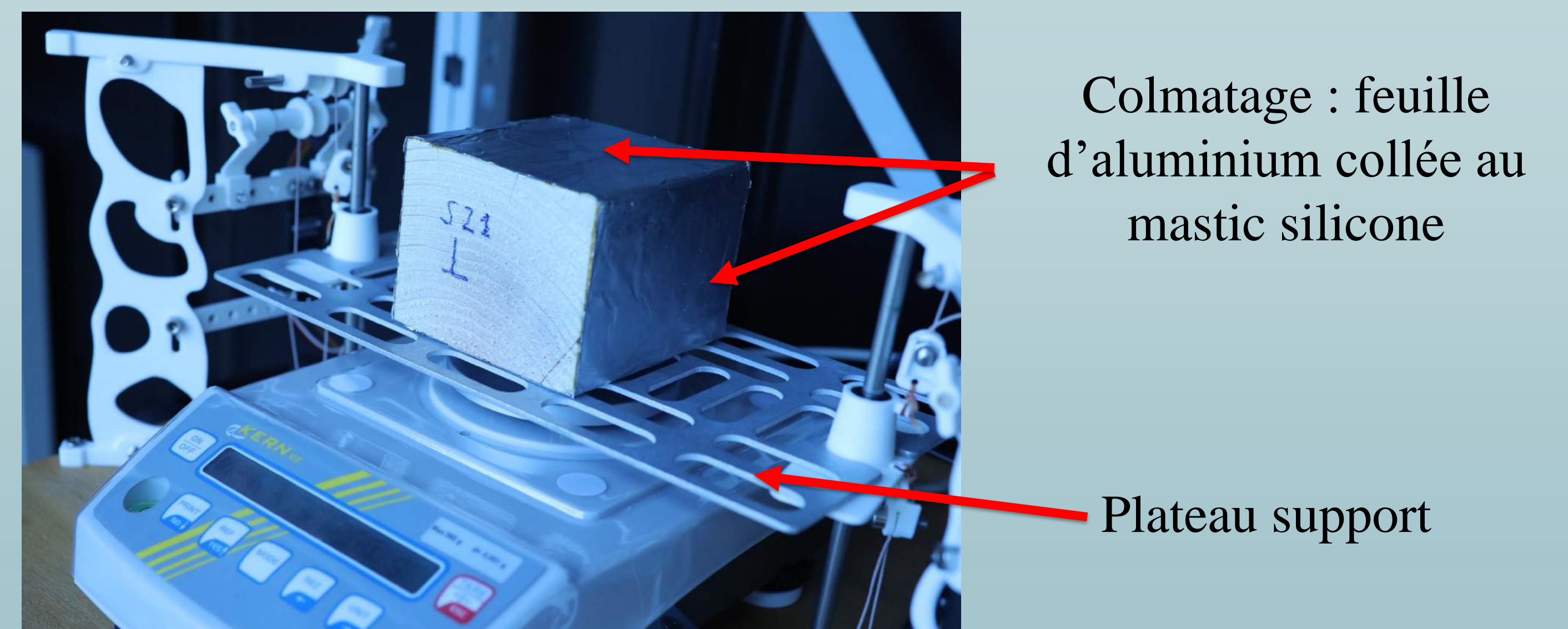
Illustration des pesées automatiques : un plateau piloté par des servomoteurs monte et redescend l'échantillon toutes les 5 minutes.
