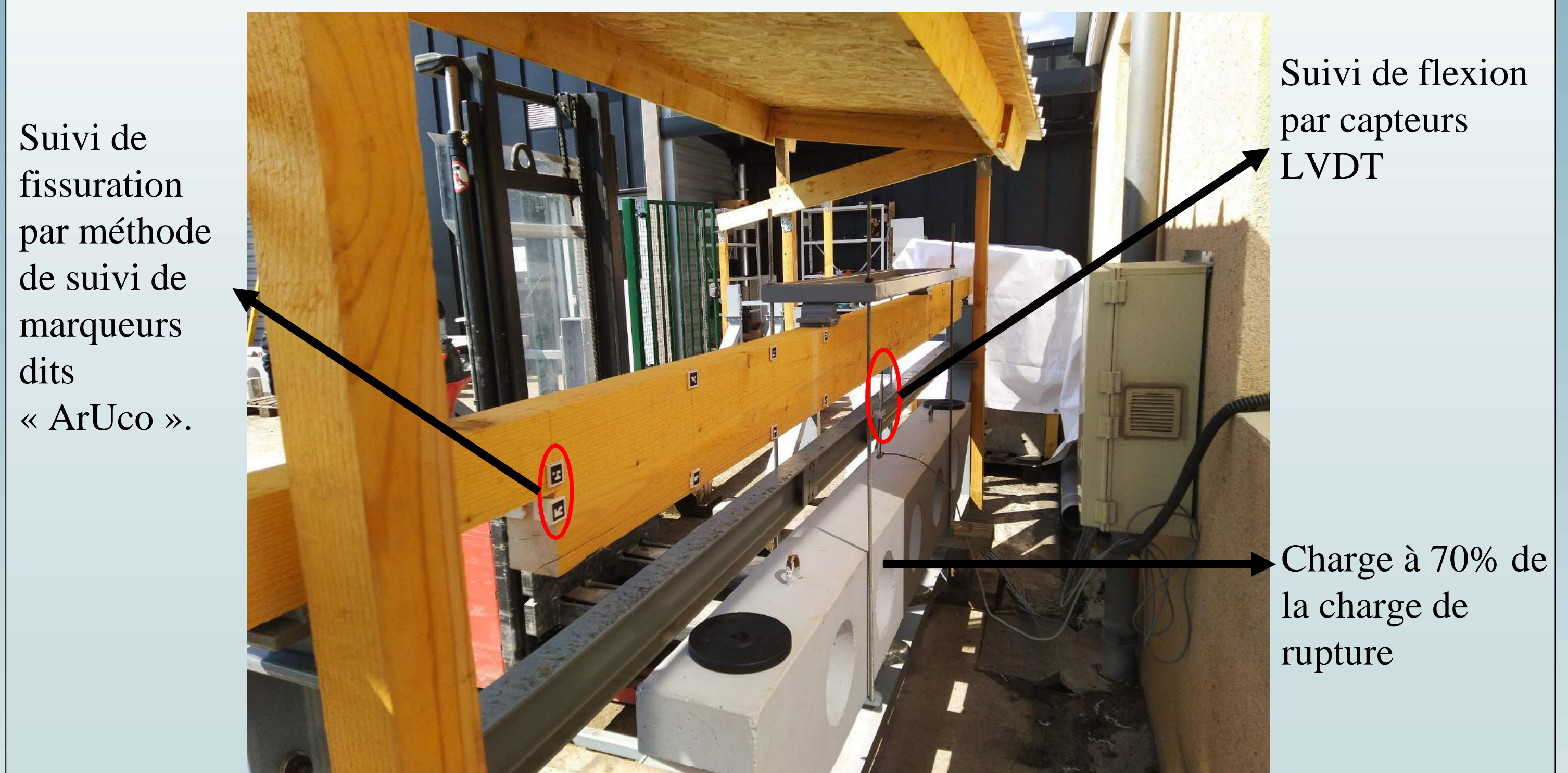
Illustration des essais de fluage en cours
